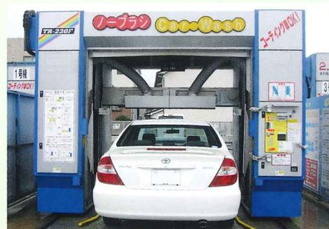
すすぎが終わると自動的に乾燥用ブロワーに切り替わり、ボディ上の水滴をムラなく吹き飛ばし、乾燥させます。
