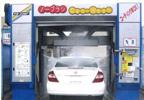
強力な洗車と特殊ワックスによって汚れが十分に落ちたところで、仕上げの後の美しさを一層高めるために、再度、高水圧の噴射によるすすぎとボディリンスを行います。
